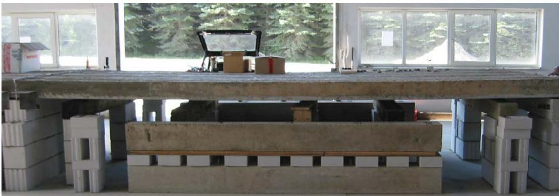
Bild 2.4.2.2.3: Durchbiegung der SVP 4-20-6,0 nach der Ortbetonergänzung
