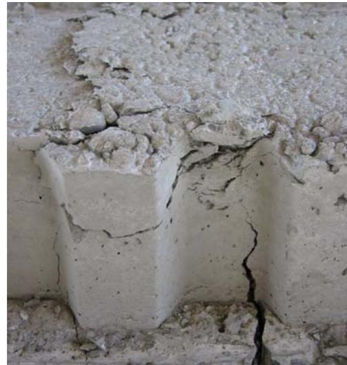
Bild 2.6.3.1: Ausbruch der Druckzonen der SVP 6-16-4,2
