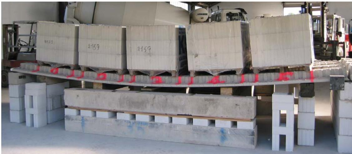
Bild 2.3.2.12: Laststufe 13 der SVP 3-16-6,0
