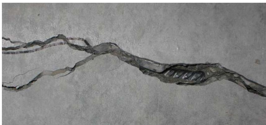
Bild 2.2.3.3: Detailaufnahme Querriss an der Plattenunterseite der SVP 2-20-4,2
