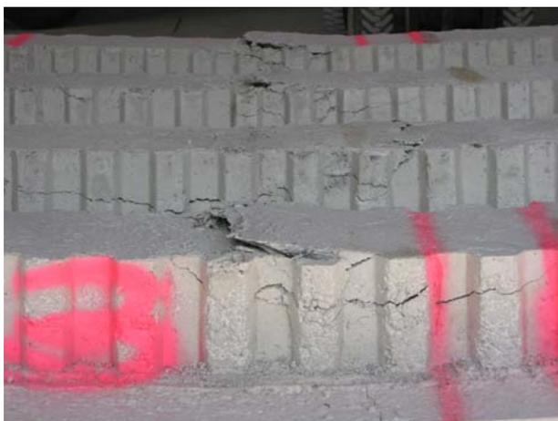
Bild 2.1.2.8: Gebrochene Druckzone der SVP 1-20-6,0
