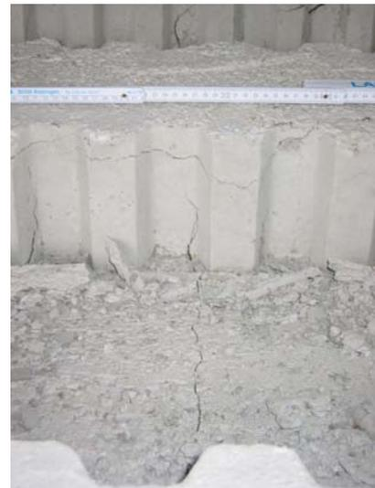
Bild 2.2.3.2: Rissbildung an der Plattenoberseite zwischen den Stegen
