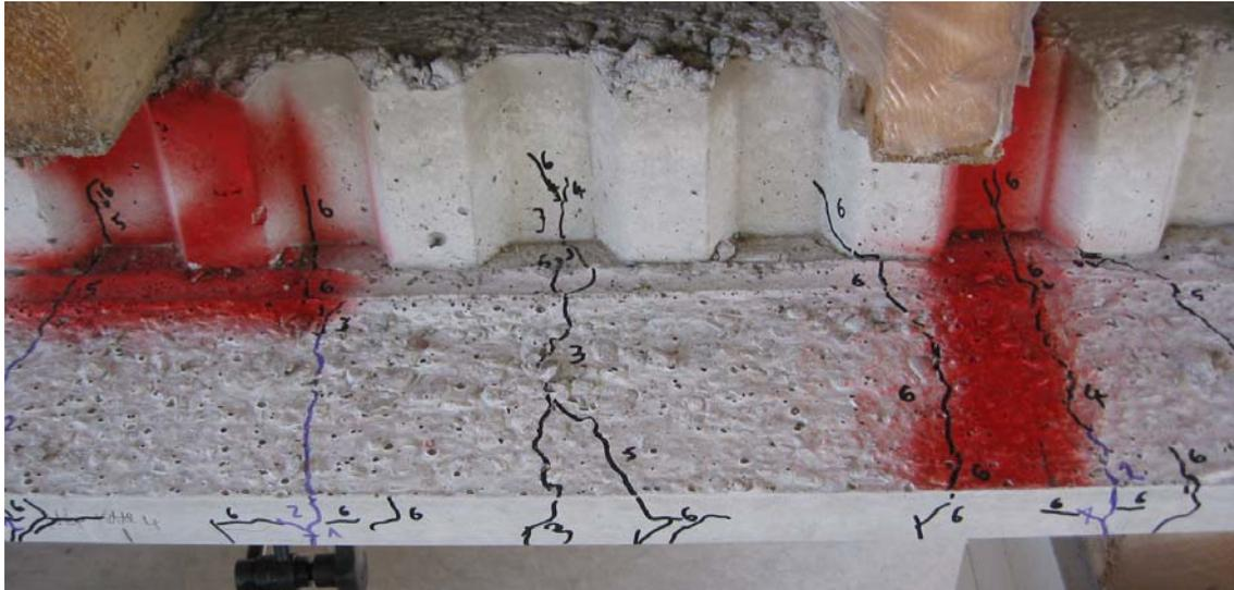
Bild 2.6.2.10: Risse an der Oberseite der SVP 6-16-4,2 am nördlichen Plattenrand
