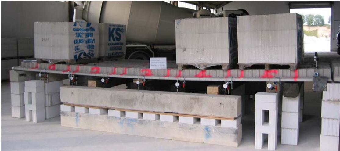
Bild 2.3.2.9: Laststufe 6 der SVP 3-16-6,0
