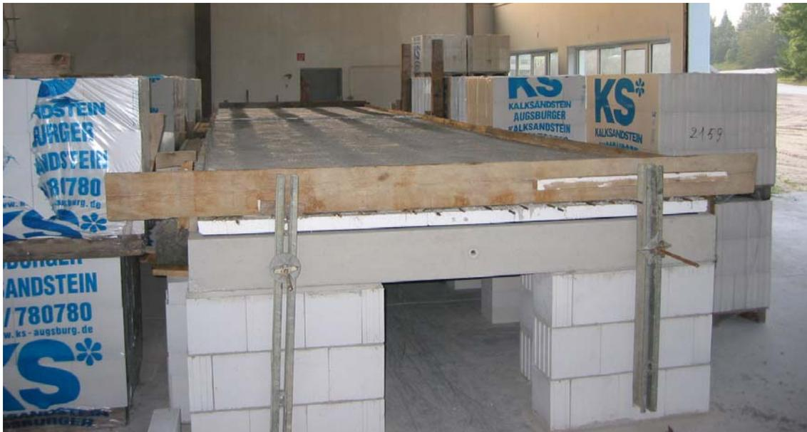
Bild 2.4.2.2.1: Abgeschaltete Stegverbundplatten
