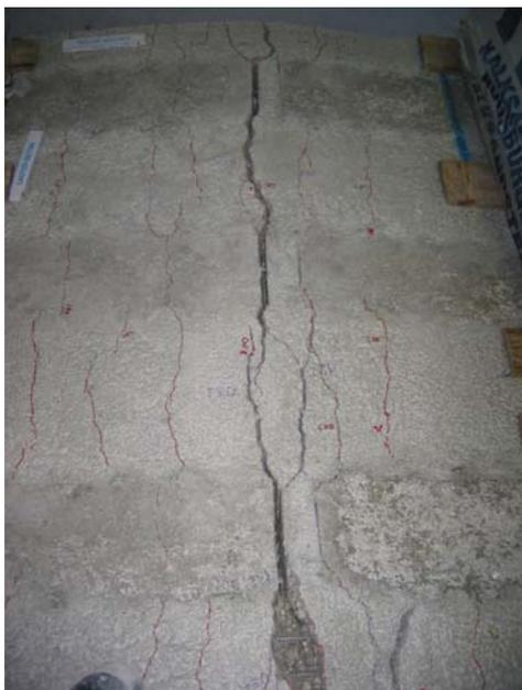
Bild 2.9.3.2: Risse über dem Auflager B
