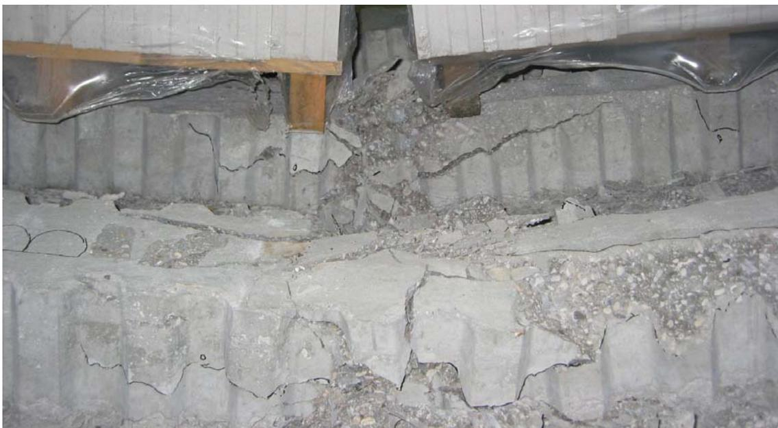
Bild 3.3.3.2: Versagte Druckzonen in Feldmitte nach der Entlastung
