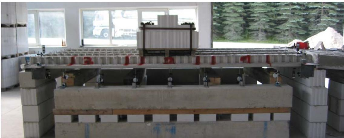
Bild 2.6.2.2: Laststufe 1 der SVP 6-16-4,2
