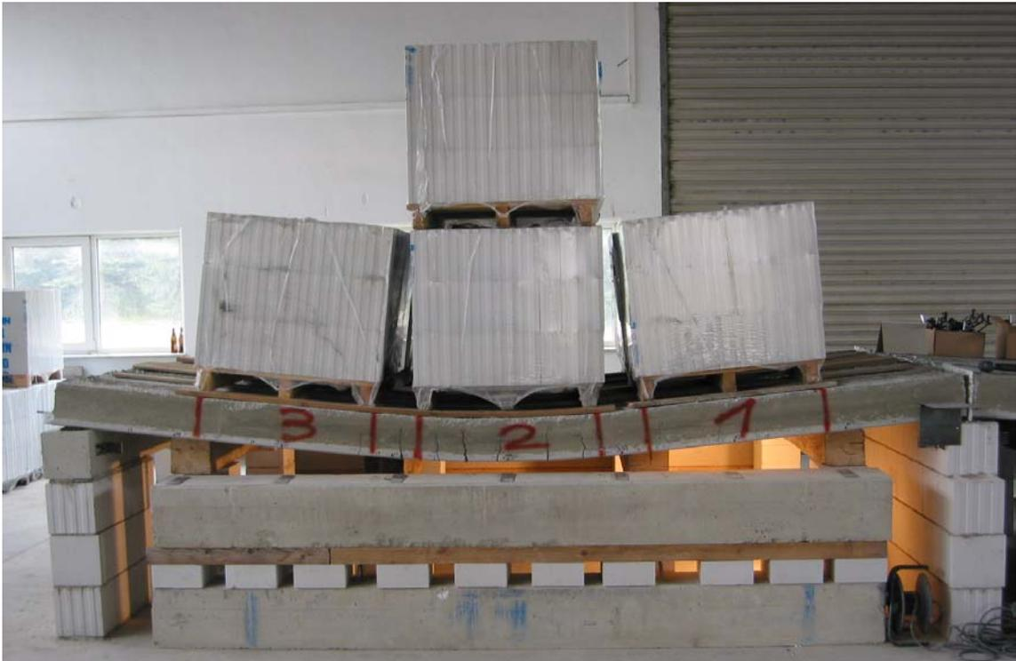
Bild 2.5.2.2.7: Laststufe 5 der SVP 5-20-4,2 mit Ortbetonergänzung
