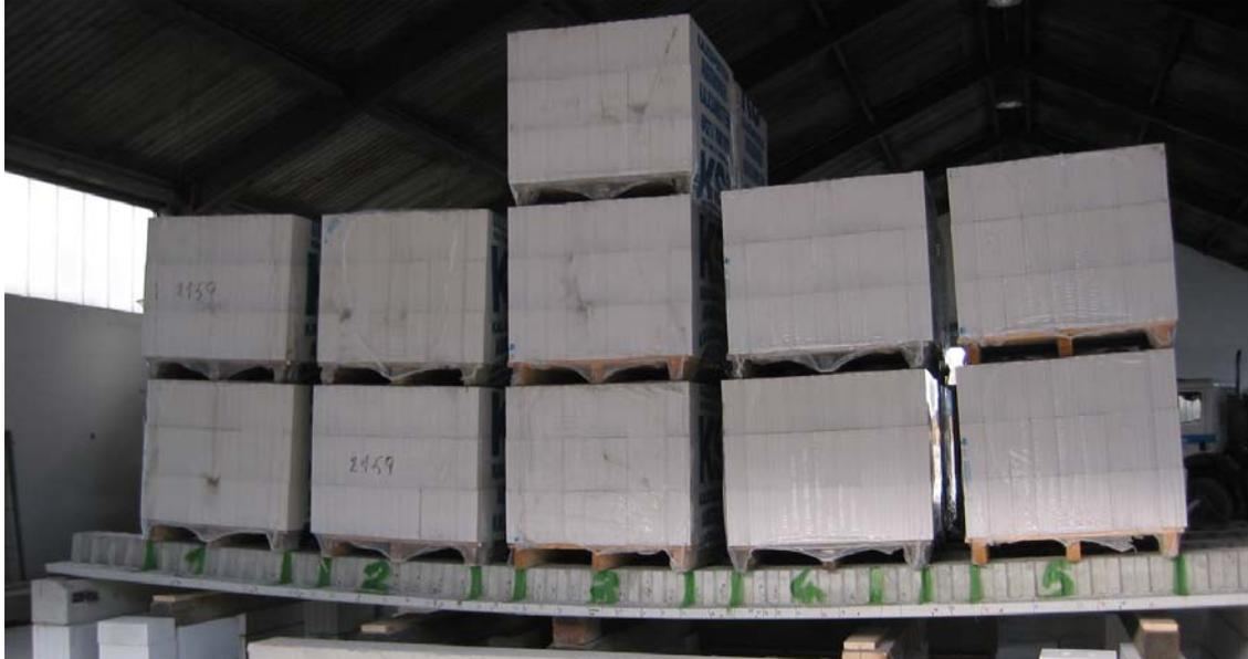
Bild 3.3.2.7: Laststufe 5 der hochfesten SVP 10-20-6,1
