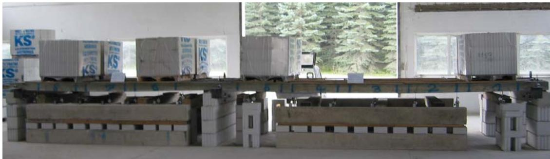
Bild 2.9.2.3: Laststufe 1 der SVP 7 und 8 als Durchlaufträger
