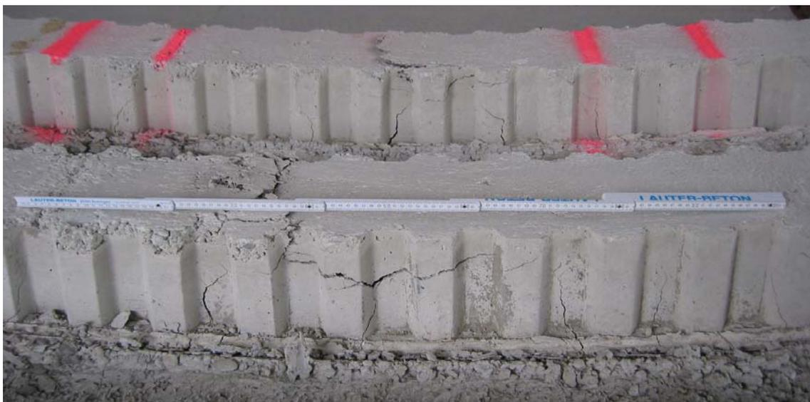
Bild 2.2.2.8: Ausbruch der Druckzone der SVP 2-20-4,2
