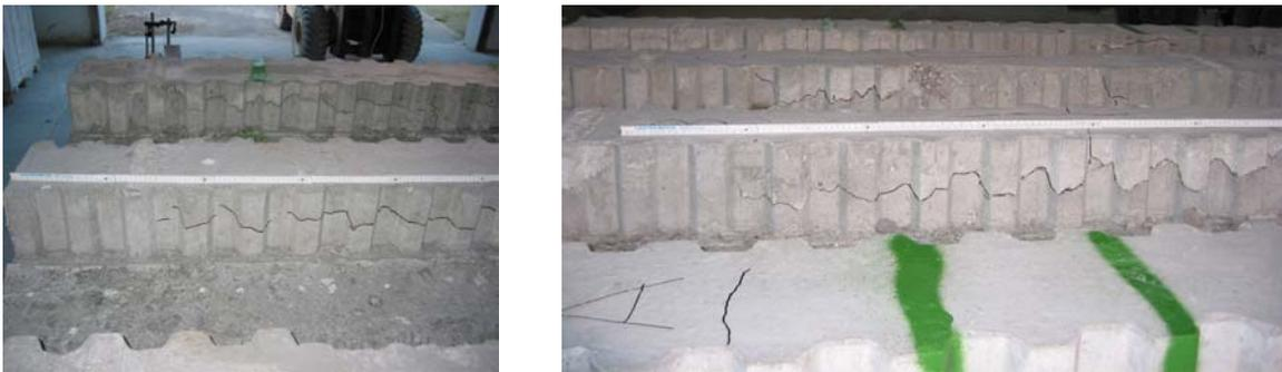
Bild 3.3.1.1: Risse an den Stegen durch verfrühtes Ausschalen der SVP 10-20-6,1 Hochfest im Auflagerbereich (links) und in Feldmitte (rechts)
