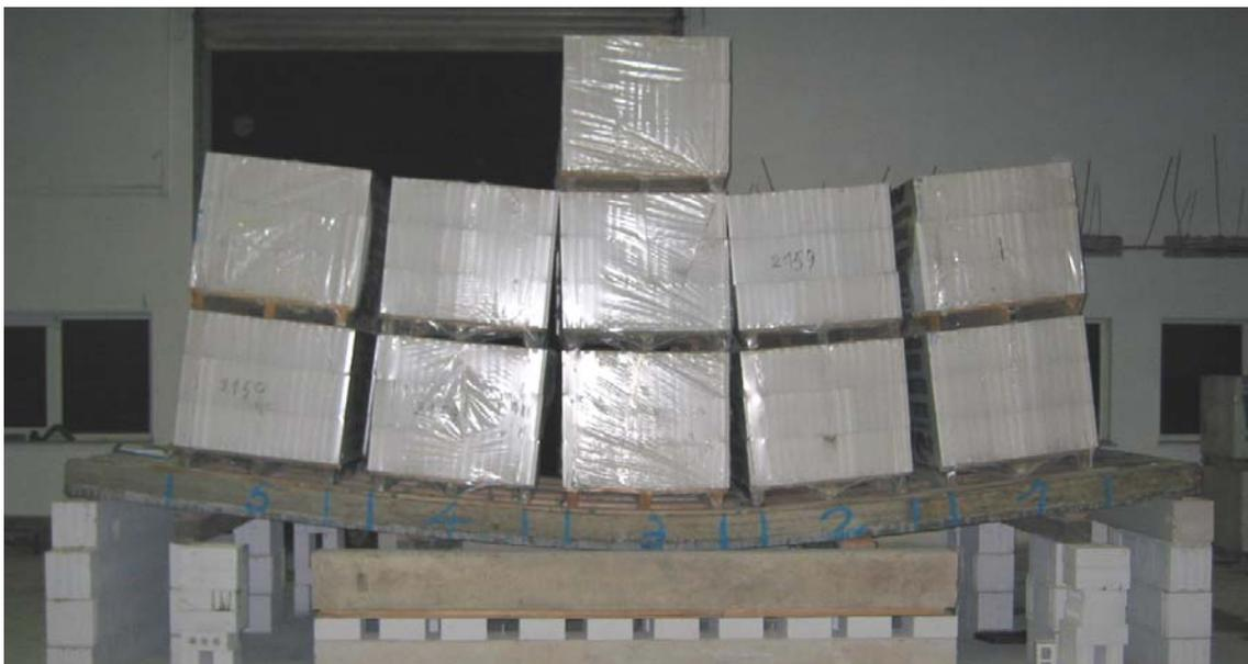
Bild 3.4.2.7: Laststufe 5 der hochfesten SVP 11-18-6,1
