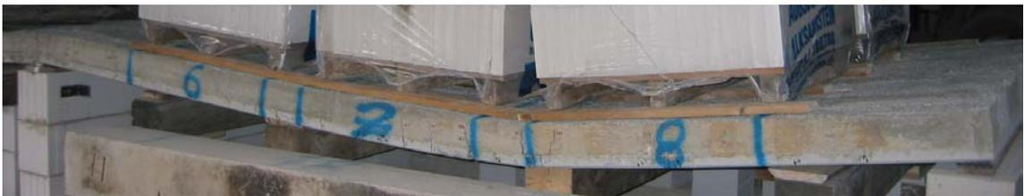
Bild 2.9.3.3: Risse an der Plattenseite der siebten und achten SVP
