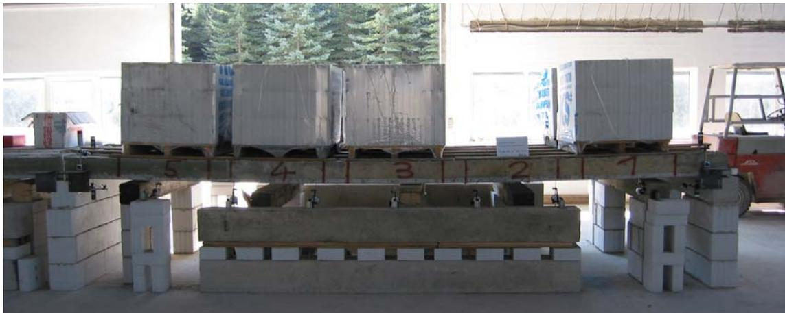
Bild 2.4.2.2.8: Laststufe 3 der SVP 4-20-6,0 mit Ortbetoneingussung
