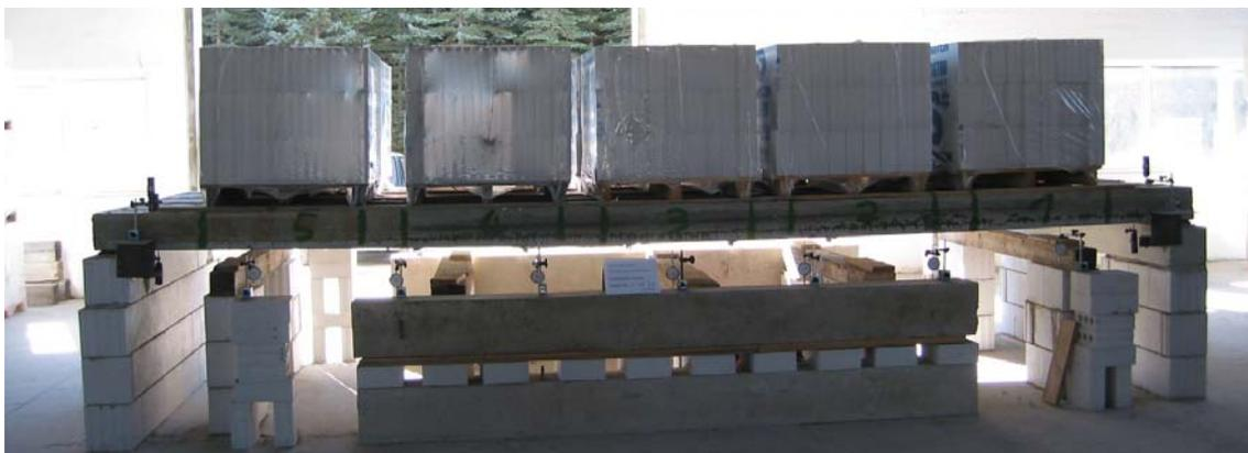
Bild 3.2.2.2: Laststufe 2 der hochfesten SVP 9-20-6,1
