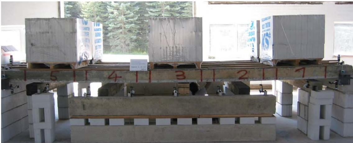
Bild 2.4.2.2.6: Laststufe 2 der SVP 4-20-6,0 mit Ortbetonergänzung
