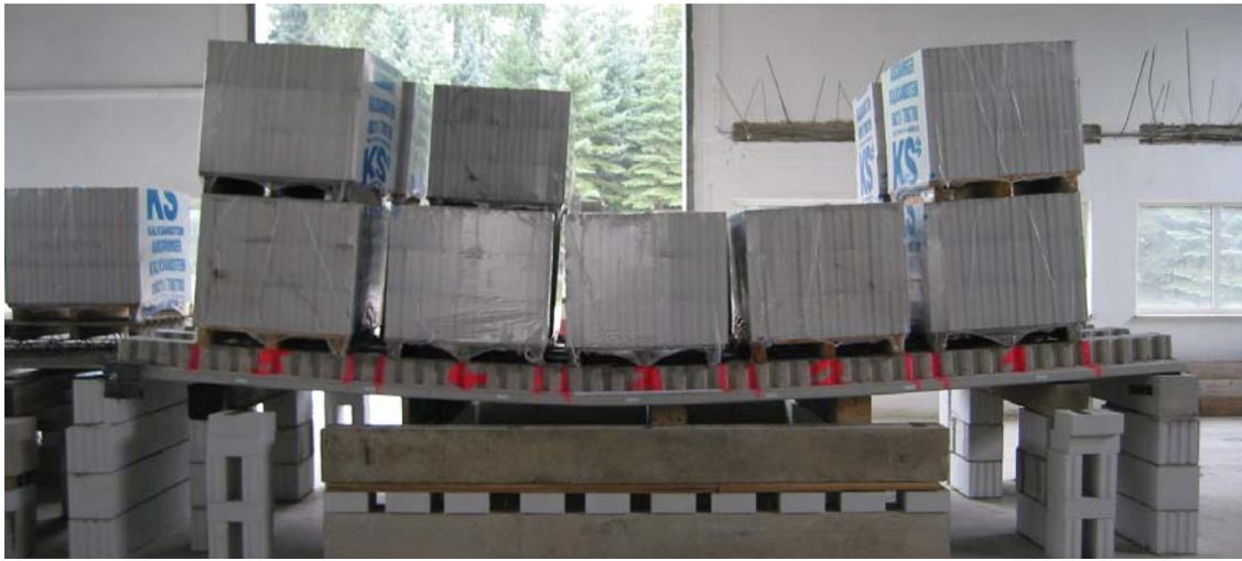
Bild 2.1.2.7: Laststufe 4 der SVP 1-20-6,0
