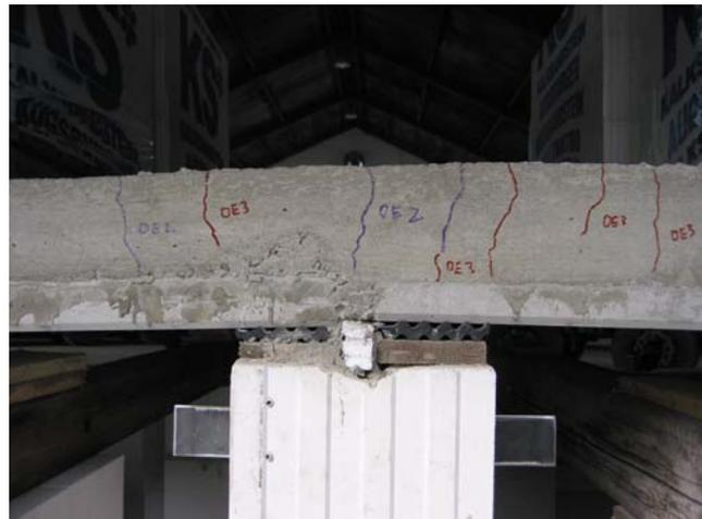
Bild 2.9.2.8: Neu entstandene Risse aus der Laststufe 3 über dem Auflager B
