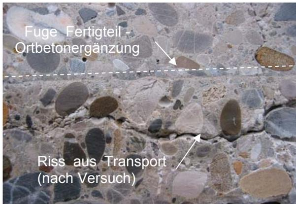
Bild 4.7: Detailaufnahme Verbundwirkung
