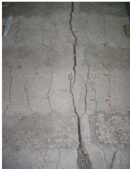
Bild 4.11: Rissbilder bei 106 % des maximalen Moments unter Gebrauchslast (links) und bei ca. 105 % des rechnerischen Bruchmoments (rechts)
