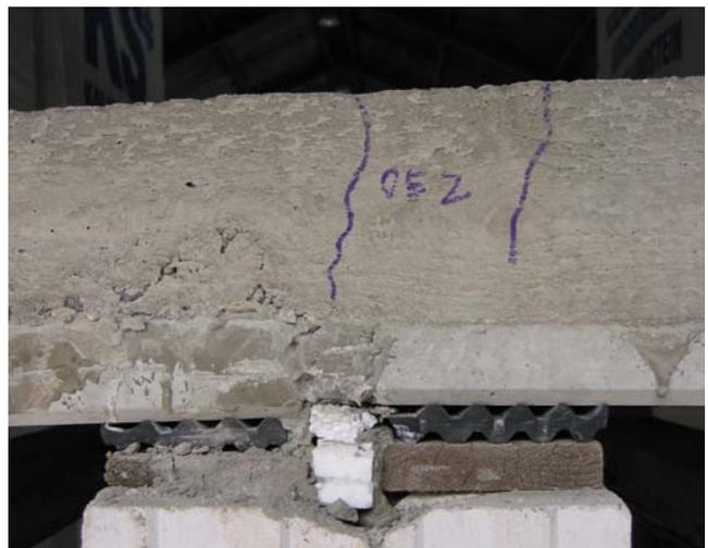
Bild 2.9.2.6: Neu entstandene Risse aus der Laststufe 2 über dem Auflager B
