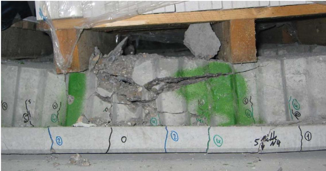
Bild 3.3.3.1: Versagte Druckzone in Feldmitte
