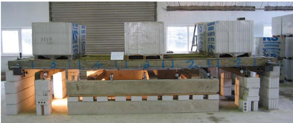
Bild 3.4.2.2: Laststufe 1 der hochfesten SVP 11-18-6,1
