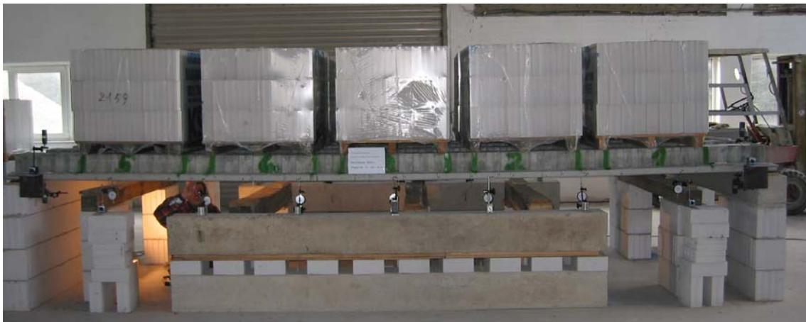
Bild 3.3.2.3: Laststufe 2 der hochfesten SVP 10-20-6,1
