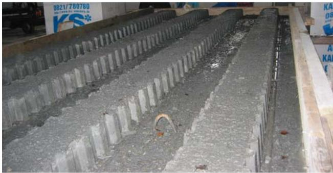
Die Stegverbundplatte wurde am 18. November 2002 auf den Versuchstand gehoben und am nächsten Tag mit dem Beton C 30 ergänzt. Die Ortbetonergänzung wurde wie bei den anderen Platten vorgenommen, so dass die Platte unterstützungsfrei auf den beiden Auflagerwänden auch während dem Aufbringen und Erhärten des Ortbetons lagerte.
