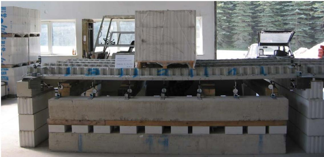
Bild 2.8.2.1: Laststufe 2 der Vorbelastung der SVP 8-16-4,2
