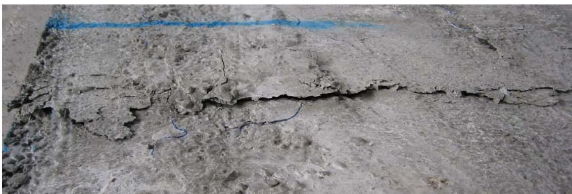
Bild 3.4.3.3: Gesamtansicht der versagten Druckzone der hochfesten SVP 11-18-6,1
