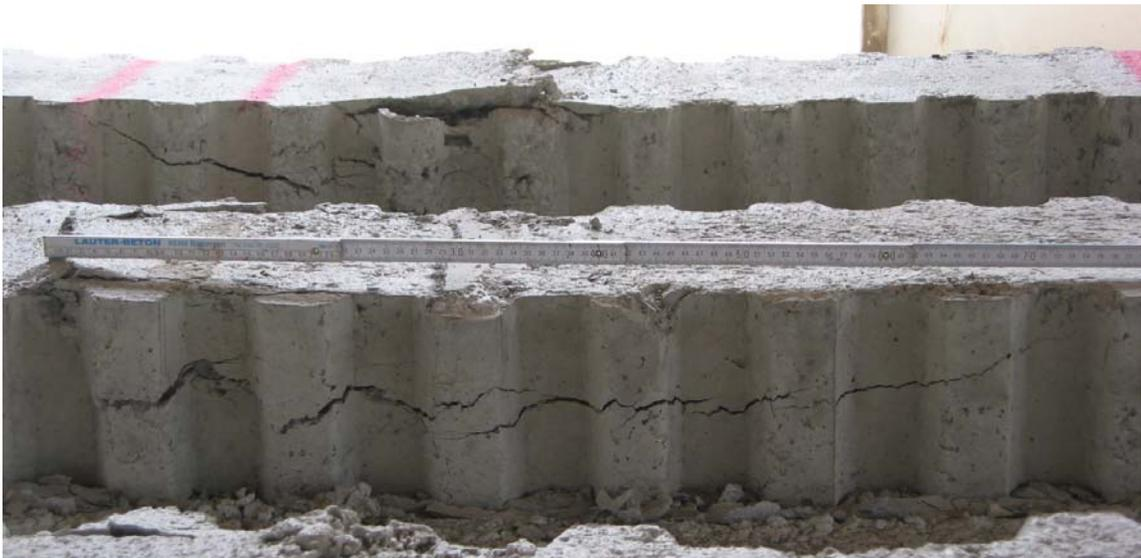
Bild 2.1.3.1: Druckzonenversagen der Stege 1 und 2 bei der SVP 1-20-6,0
