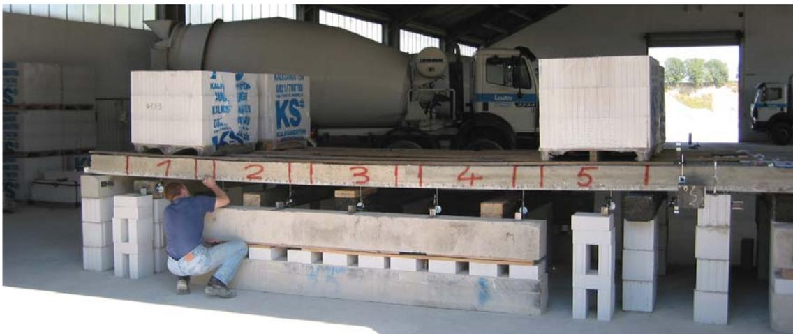
Bild 2.4.2.2.4: Laststufe 1 der SVP 4-20-6,0 mit Ortbetonergänzung
