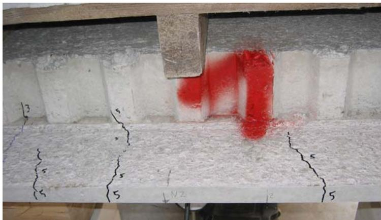
betrug. An der Plattenunterseite entstanden zum Auflager A hin neue Risse mit Weiten von 0,1 – 0,3 mm. Diese neu entstandenen Risse reichten teilweise bereits bis zu den Stegen an der Plattenoberseite. Die alten Risse an der Plattenunterseite und in Feldmitte hatten eine Weite von 0,3 – 0,4 mm und die in Richtung zu den Auflagern von 0,2 – 0,25 mm.
