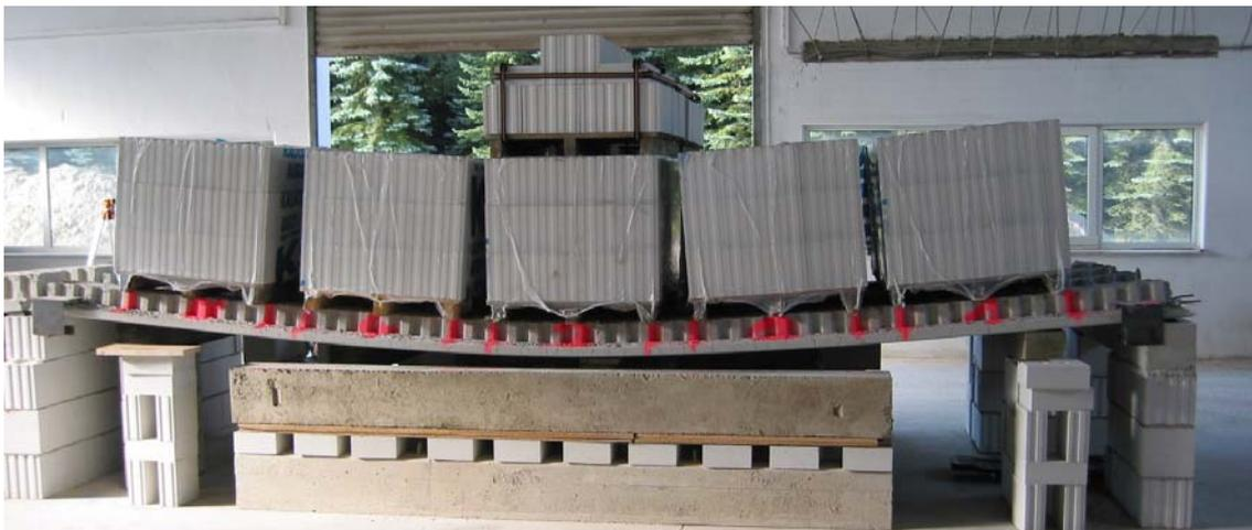
Bild 2.3.2.13: Laststufe 14 der SVP 3-16-6,0
