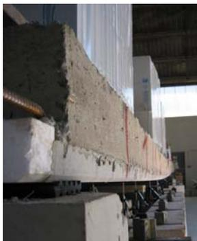
Während sich die rechnerische Durchbiegung im Zustand II von 12,43 auf 16,00 mm in Feldmitte erhöhte, wuchs die gemessene von 34,45 auf 44,6 mm an. Betrachtet man hingegen das Verhältnis der Zunahme der Durchbiegungen, so ist zu erkennen, dass beide eine Vergrößerung von 30 % aufwiesen. Die Zunahme des Moments in Feldmitte lag bei 36 %.
