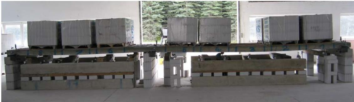
Bild 2.9.2.4: Laststufe 2 der SVP 7 und 8 als Durchlaufträger
