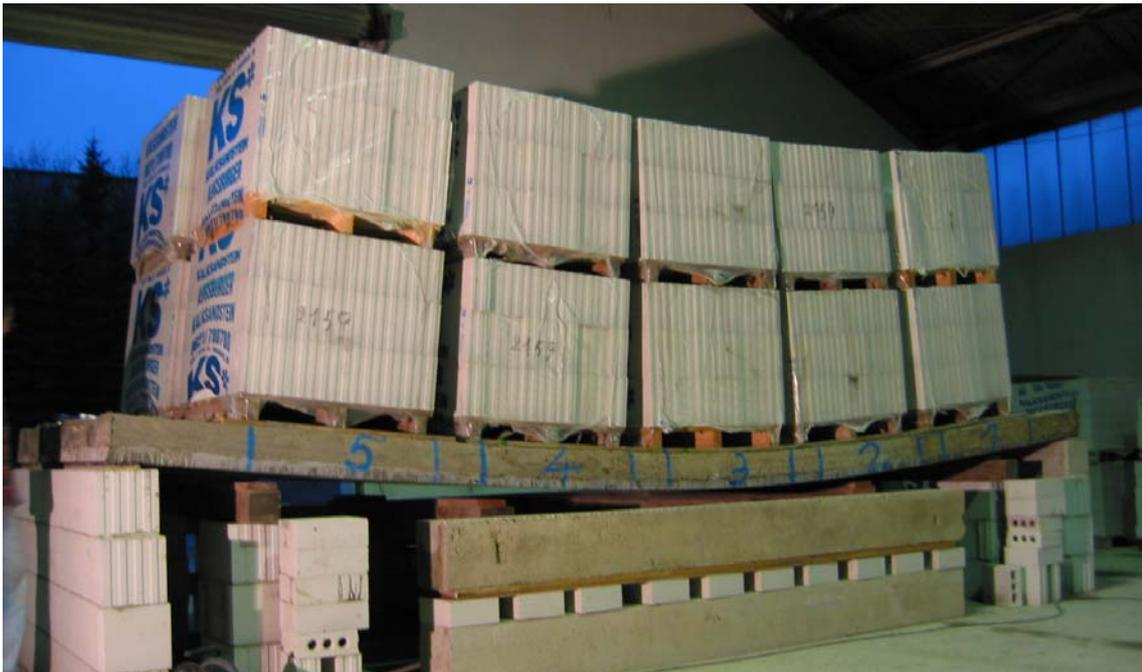
Bild 3.4.2.6: Laststufe 4 der hochfesten SVP 11-18-6,1
