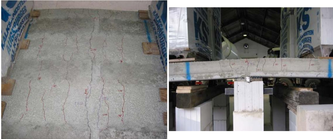
Bild 2.9.2.12: Risse aus der Laststufe 5 über dem Auflager B der SVP 7 und 8
