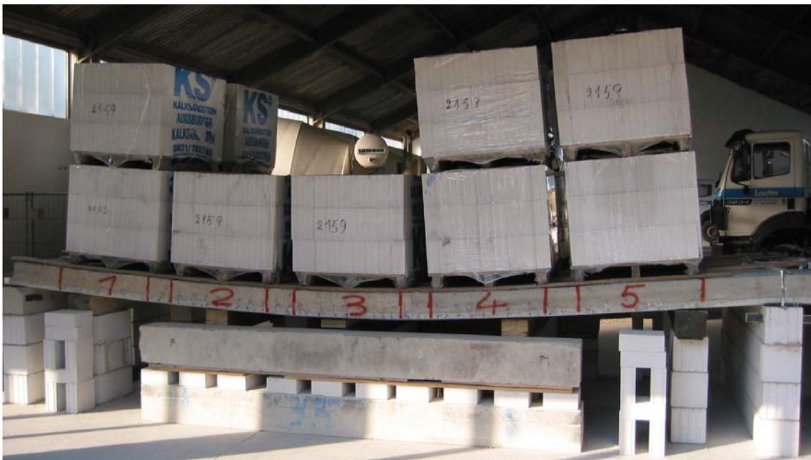
Bild 2.4.2.2.17: Laststufe 7 der SVP 4-20-6,0 mit Ortbetonergänzung
