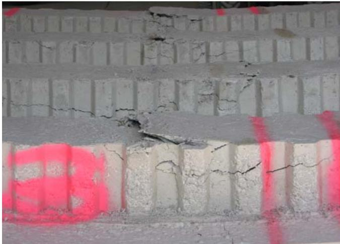
Bei den Stegverbundplatten der ersten Versuchsreihe versagte in der Biegedruckzone das Betongefüge, während bei den Platten mit hochfesten Betonen der Zuschlag zerbrach. Das *Bild 4.1* zeigt das Ausbrechen der Druckzone bei einer Stegverbundplatte der Betongüte C 30. Deutlich ist zu erkennen, wie sich bereits Ausbruchschollen gebildet hatten.
