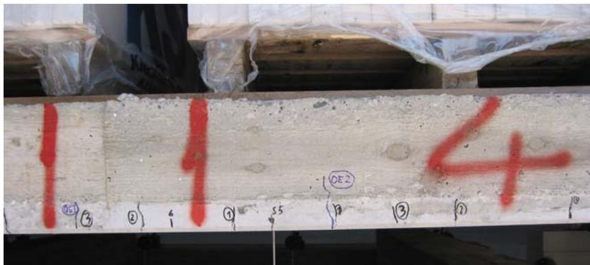
Bild 2.4.2.2.12 Risse aus der Laststufe 4 in Feldmitte
