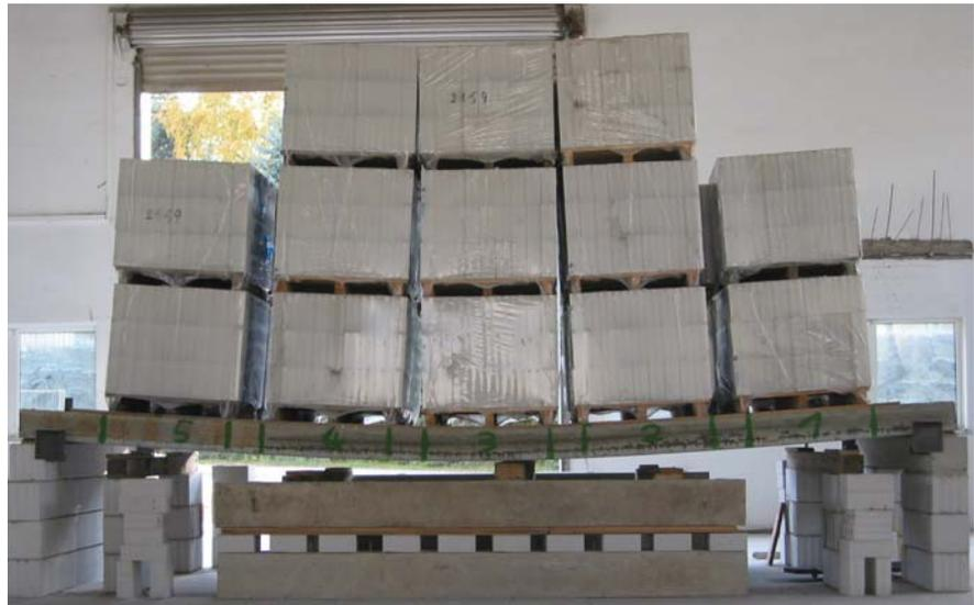
Bild 3.2.2.8: Laststufe 6 der hochfesten SVP 9-20-6,1
