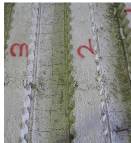
Bild 2.6.3.2: Risse an der Unter- und Oberseite der SVP 6-16-4,2
