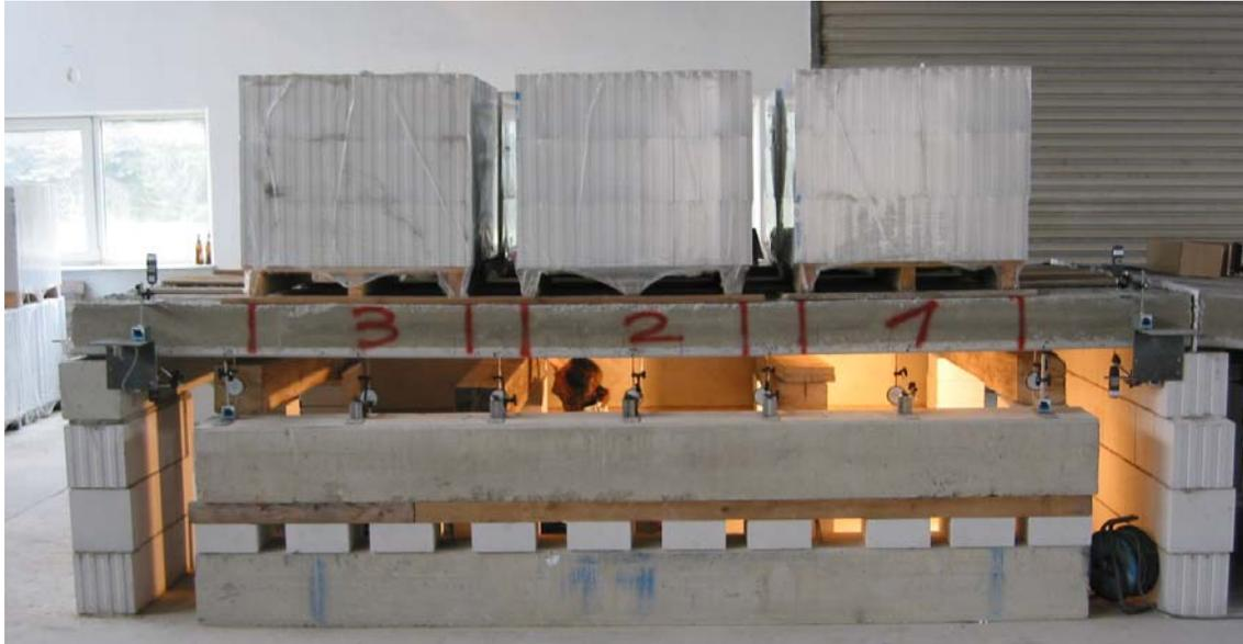
Bild 2.5.2.2.3: Laststufe 2 der SVP 5-20-4,2 mit Ortbetonergänzung
