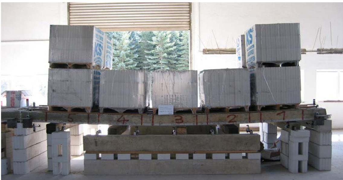
Bild 2.4.2.2.13: Laststufe 5 der SVP 4-20-6,0 mit Ortbetoneergänzung
