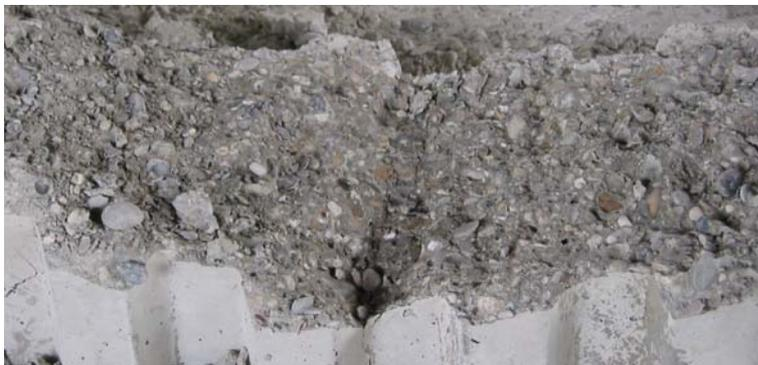
Das *Bild 4.2* zeigt das gebrochene Gefüge in der Ausbruchsfläche der Druckzone. Deutlich ist zu erkennen, wie nicht der Zuschlag, sondern das Gefüge gerissen ist. Die Rundungen der Kieskörner sind eindeutig zu erkennen.
