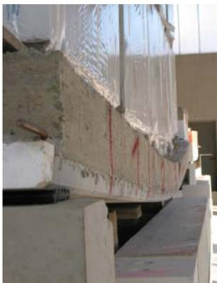
Bei dieser Laststufe konnte die Durchbiegung nicht mehr festgestellt werden, da die Platte kein Gleichgewicht mehr fand und die Durchbiegung stetig aber sehr langsam weiter zunahm. Die Durchbiegung der Platte ist im nachfolgenden Bild nochmals verdeutlicht.
