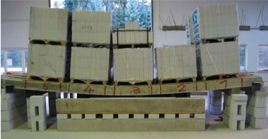
Bild 2.4.2.2.19: Laststufe 8 der SVP 4-20-6,0 mit Ortbetonergänzung
