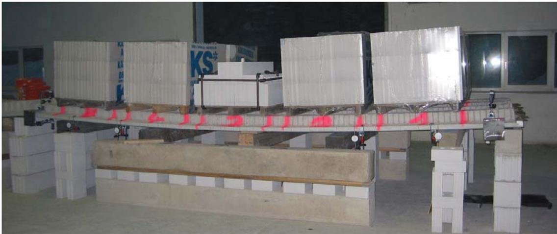
Bild 2.3.2.11: Laststufe 11 der SVP 3-16-6,0
