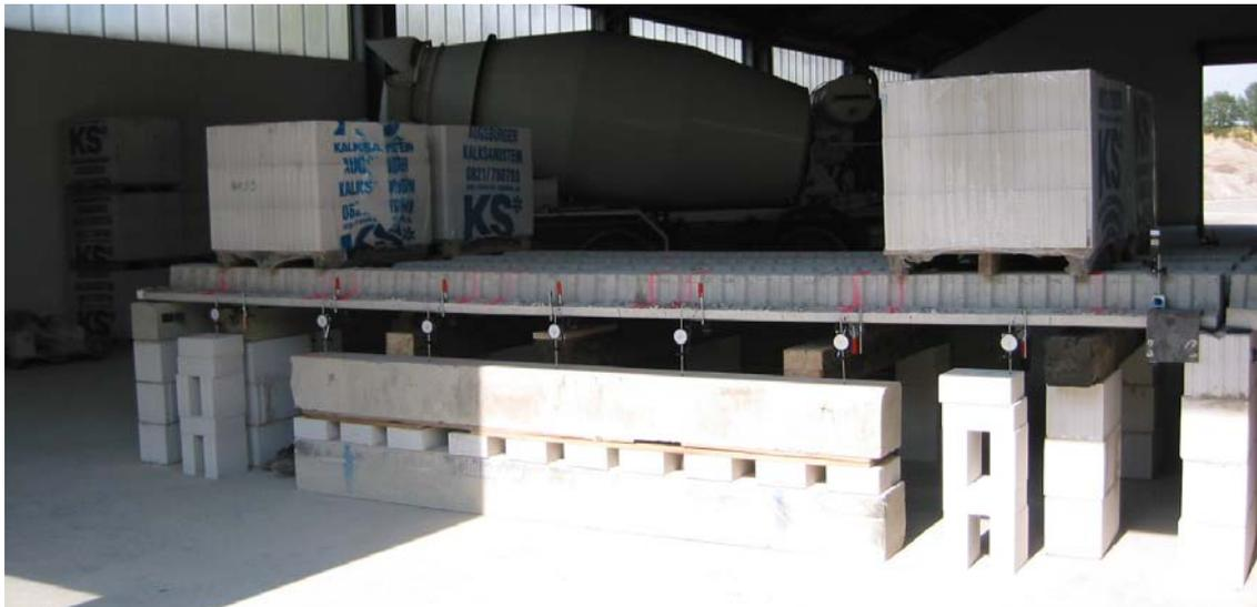
Bild 2.4.2.1.2: Laststufe 1 der SVP 4-20-6,0
