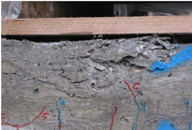
Es deutete sich auch das Versagen der Druckzone an ein paar Stellen an. Wie im nebenstehenden Bild zu sehen ist, brach in Feldmitte der obere Teil der Platte, der die Druckzone bildet. Die Druckzone wurde regelrecht zerstört, so dass kleine Betonteile herausplatzten.
