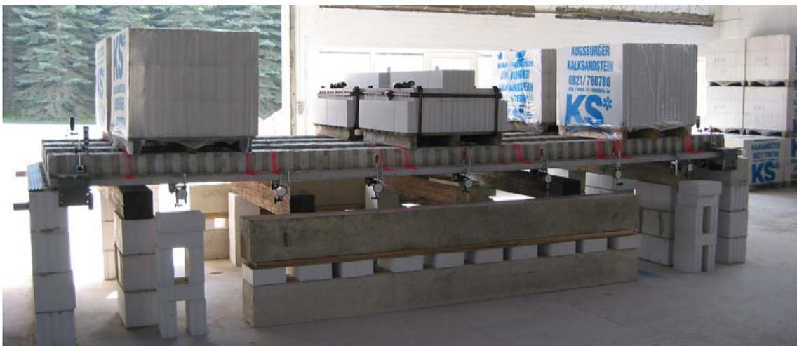
Bild 2.4.2.1.4: Laststufe 3 der SVP 4-20-6,0
