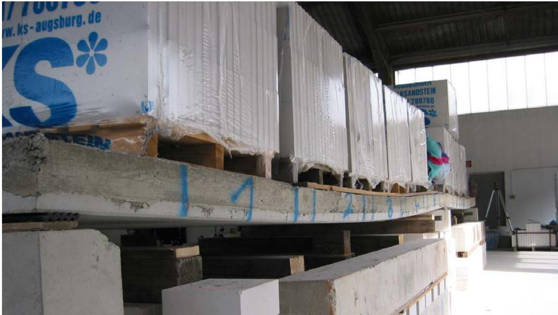
Bild 2.9.2.7: Laststufe 3 der SVP 7 und 8 als Durchlaufträger
