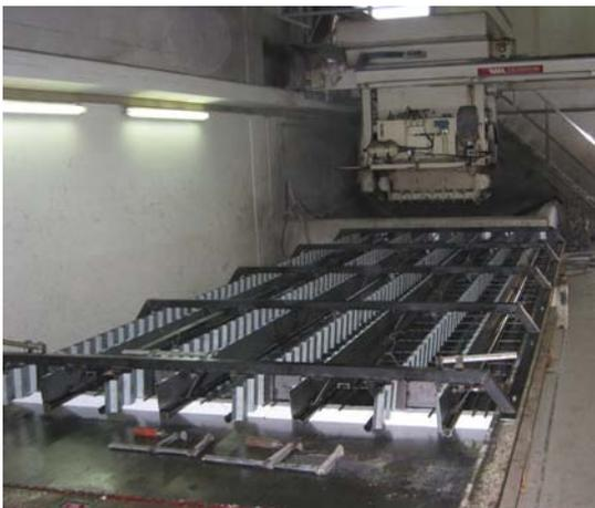
Bild 2.1.1.2: Betonierkammer
