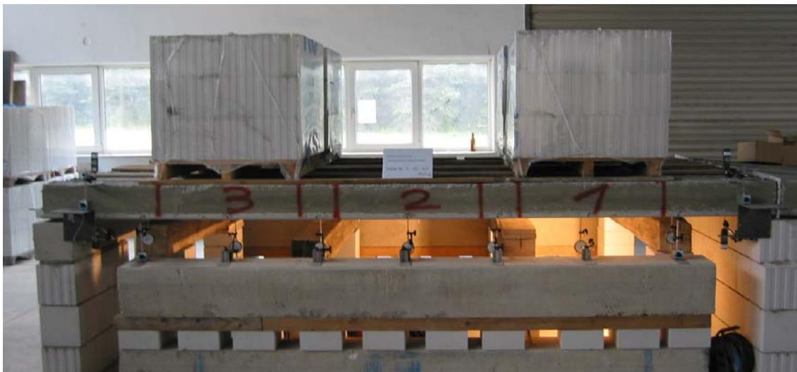
Bild 2.5.2.2.2: Laststufe 1 der SVP 5-20-4,2 mit Ortbetoneergänzung
