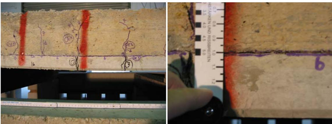
Bild 2.4.3.3: Riss zwischen Ortbetoneergänzung und Fertigteilplatte
