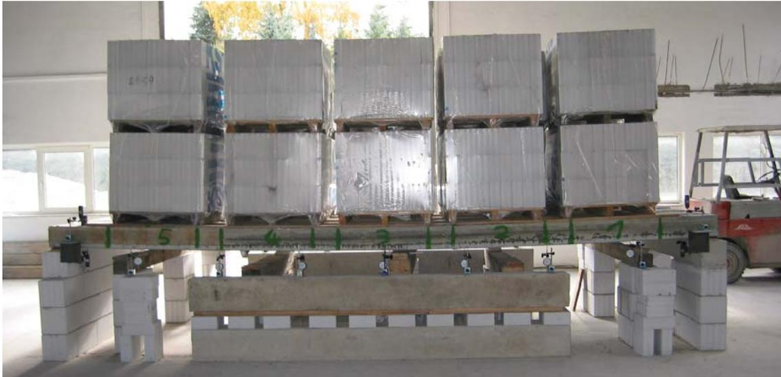
Bild 3.2.2.6: Laststufe 4 der hochfesten SVP 9-20-6,1
