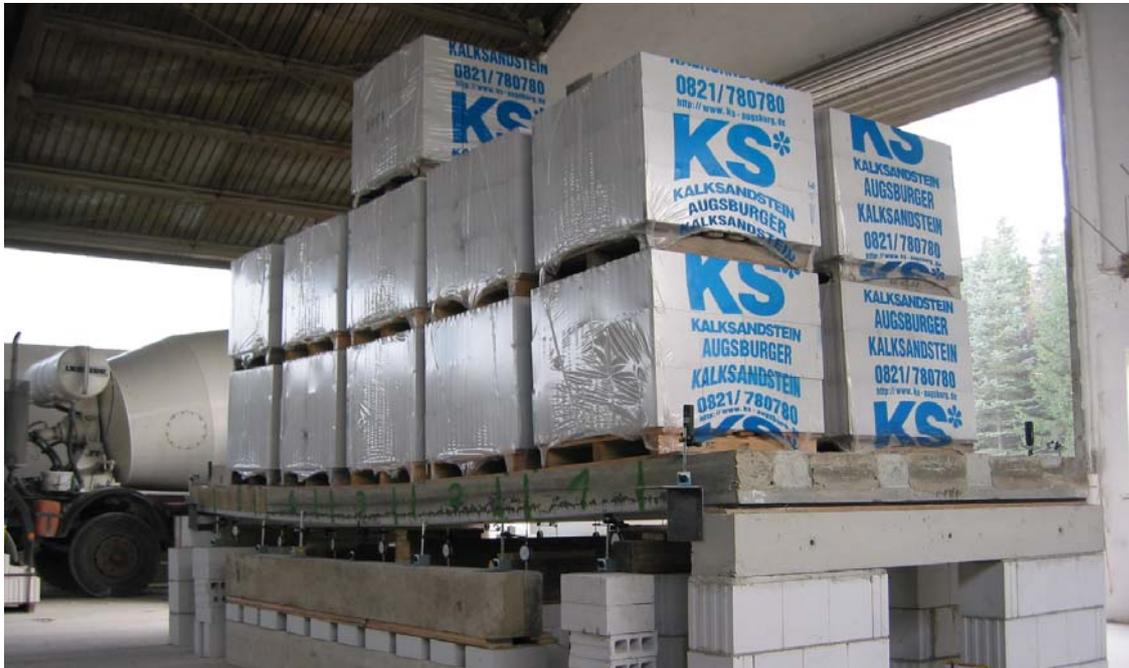
Bild 3.2.2.7: Laststufe 5 der hochfesten SVP 9-20-6,1
