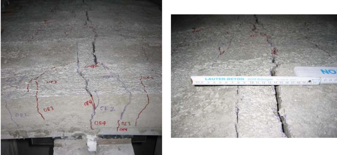
Bild 2.9.2.14: Risse über dem Auflager B bei der Laststufe 6
