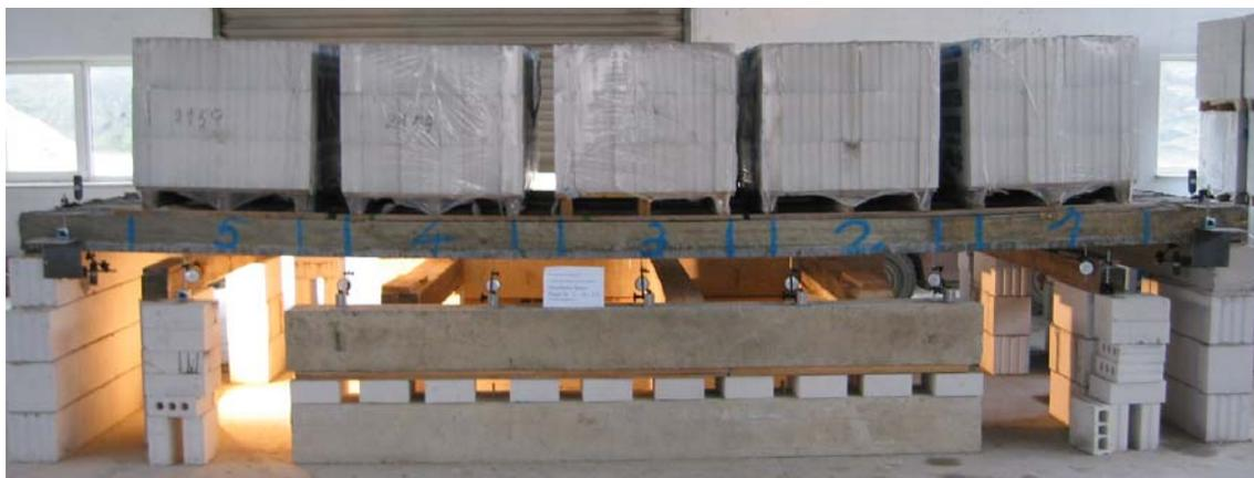
Bild 3.4.2.4: Laststufe 2 der hochfesten SVP 11-18-6,1
