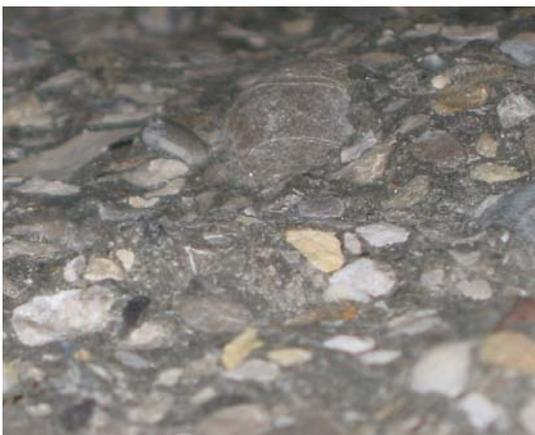
Beim Bruch der hochfesten Stegverbundplatte im Bauzustand bildeten sich nicht nur Ausbruchschollen wie bei der ersten Versuchsreihe. Der Beton in der Druckzone wurde regelrecht zerkleinert, so dass durch das schlagartige Versagen der Platte Betonsplitter entstanden. Hier war nicht das Betongefüge der schwache Punkt, sondern die Zuschläge zerbrachen. Das Bild 4.4 zeigt in einer Detailaufnahme die gebrochenen Zuschlagstoffe einer hochfesten Stegverbundplatte.
