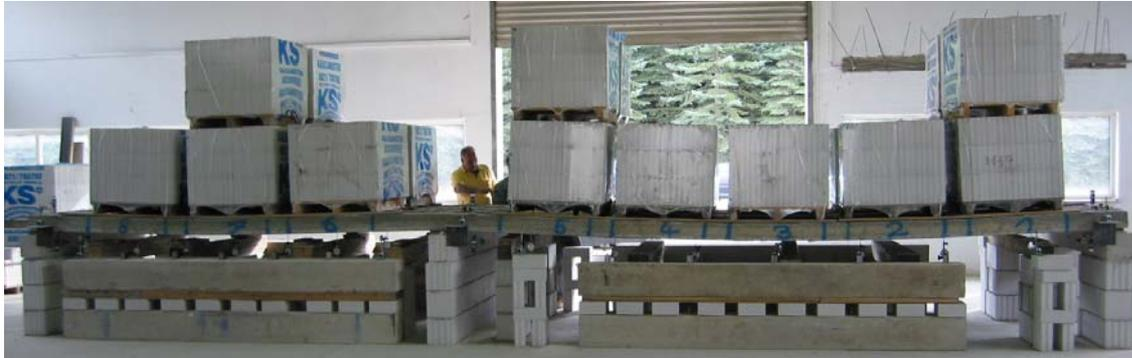
Bild 2.9.2.9: Laststufe 4 der SVP 7 und 8 als Durchlaufräger
