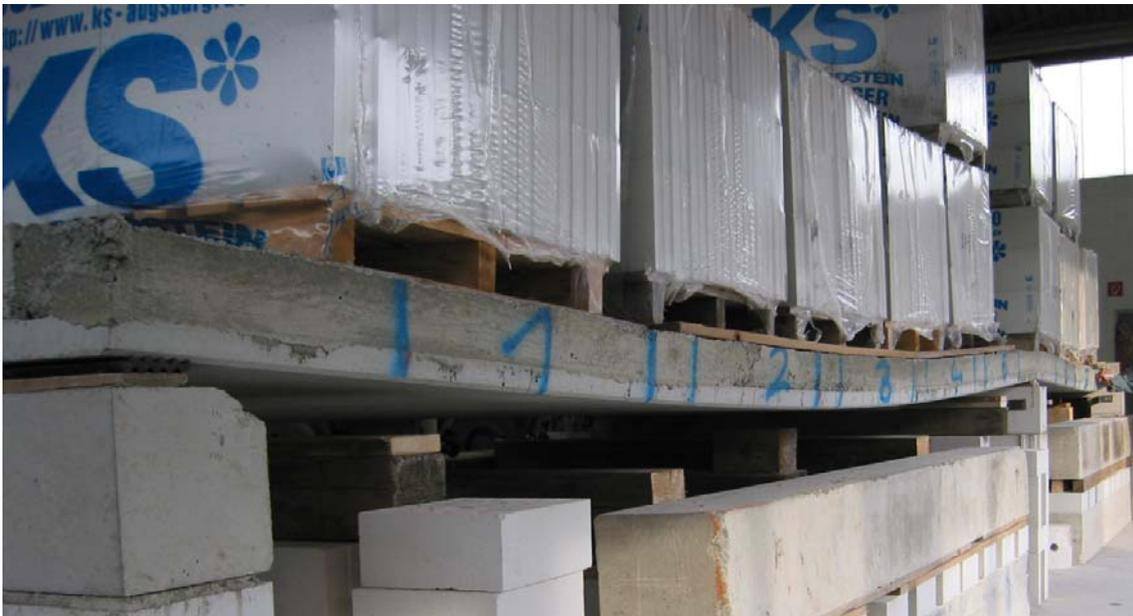
Bild 2.9.2.11: Laststufe 5 der SVP 7 und 8 als Durchlaufträger
