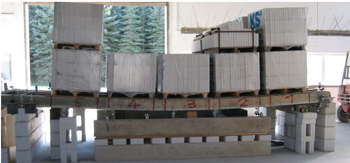
Bild 2.4.2.2.15: Laststufe 6 der SVP 4-20-6,0 mit Ortbetonergänzung
