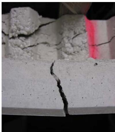
Bild 2.1.3.2: Gebrochene Platte der SVP 1-20-6,0
