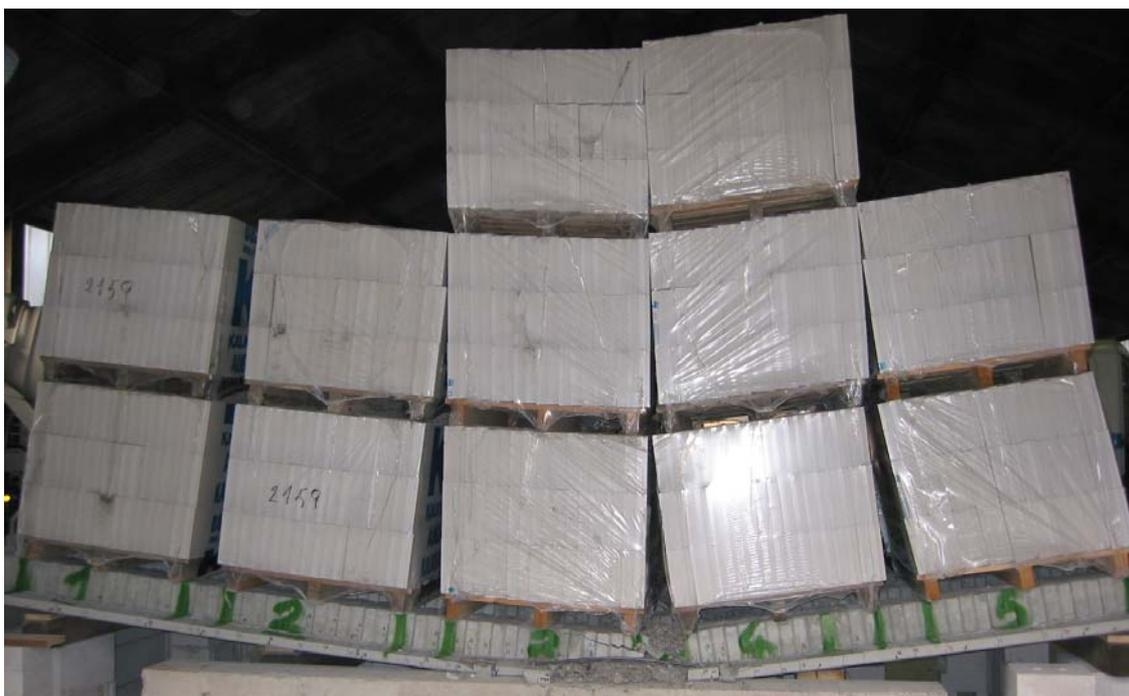
Bild 3.3.2.8: Laststufe 5 der hochfesten SVP 10-20-6,1
