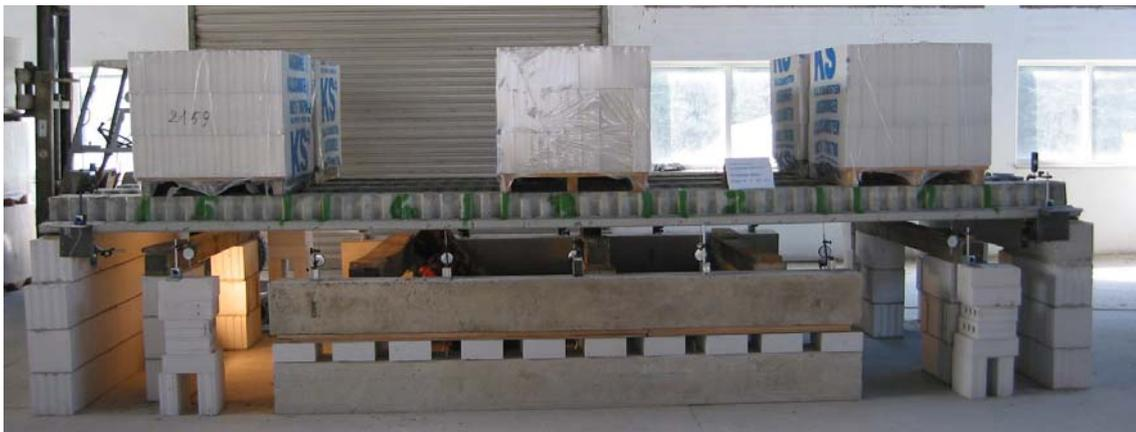
Bild 3.3.2.1: Laststufe 1 der hochfesten SVP 10-20-6,1
