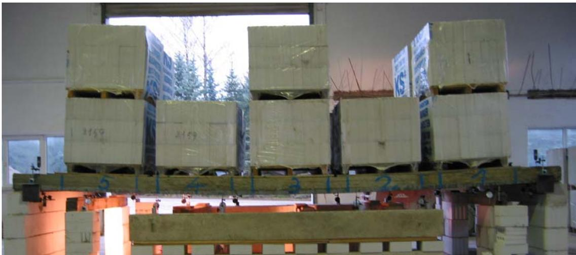
Bild 3.4.2.6: Laststufe 3 der hochfesten SVP 11-18-6,1
