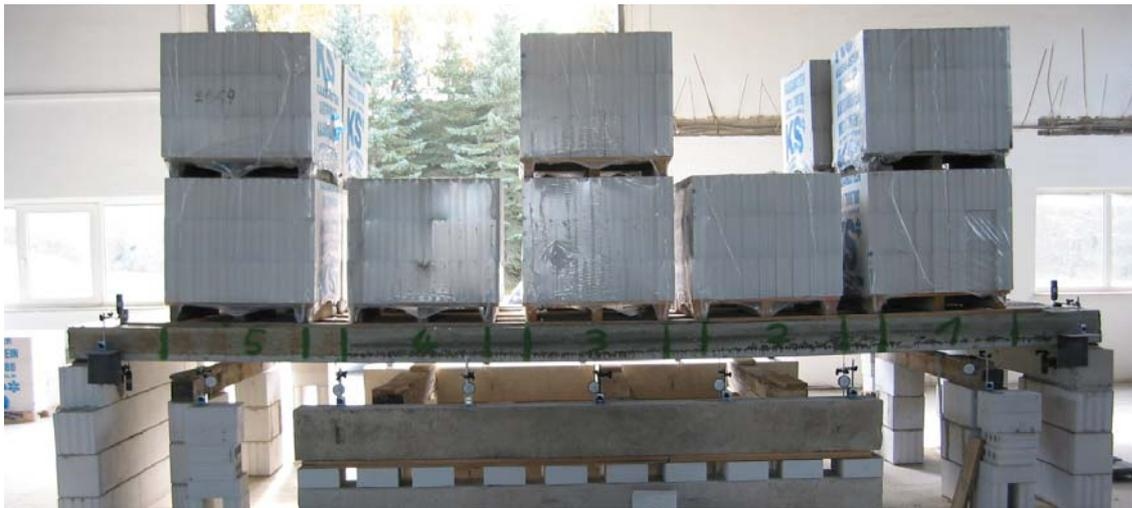
Bild 3.2.2.4: Laststufe 3 der hochfesten SVP 9-20-6,1
