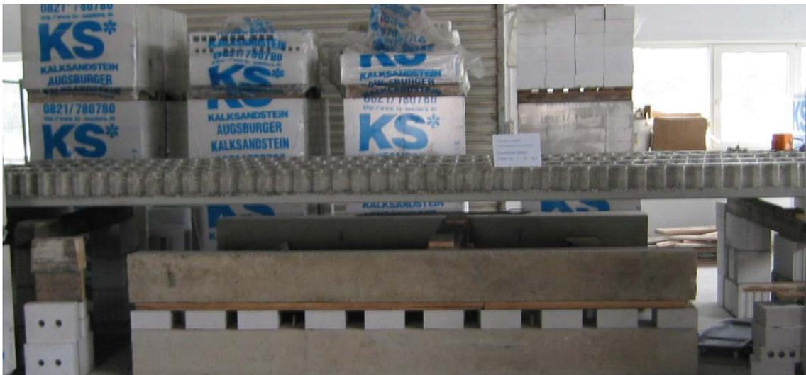
Bild 3.2.1.1: Hochfeste SVP 1-20-6,1 nach dem Auflegen auf den Versuchsstand
