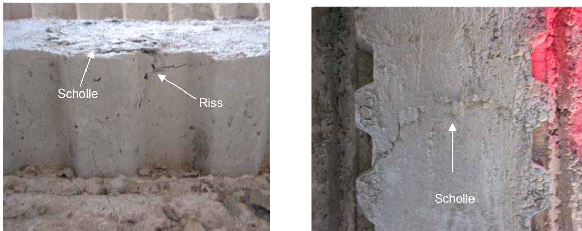
Bild 2.3.3.1 und 2.3.3.2 Versagen der Druckzone
