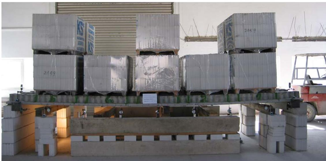
Bild 3.3.2.5: Laststufe 3 der hochfesten SVP 10-20-6,1
