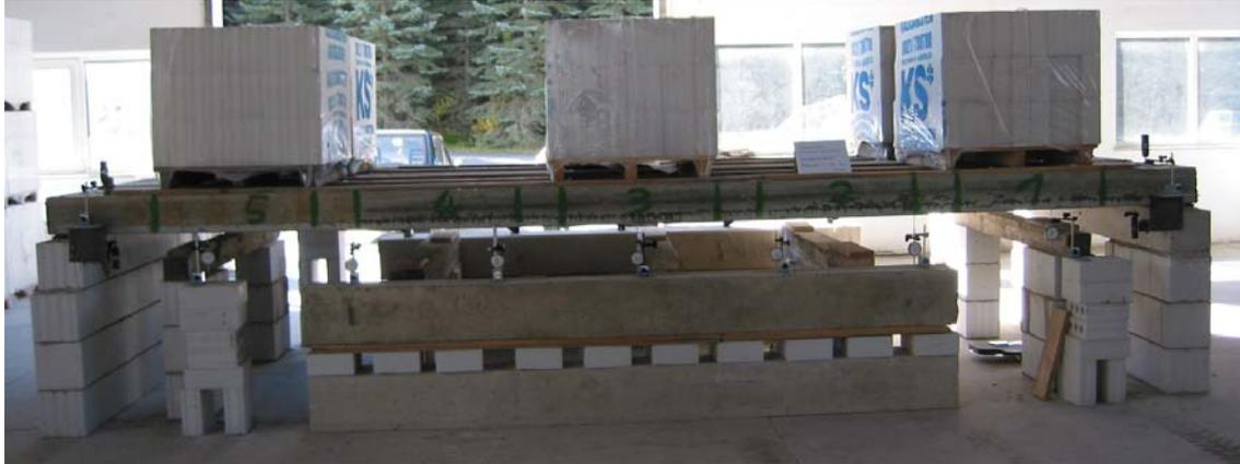
Bild 3.2.2.1: Laststufe 1 der hochfesten SVP 9-20-6,1
