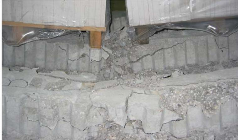
Bild 4.3: Versagen der Druckzonen bei den hochfesten Stegverbundplatten
